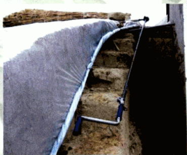
▲ 节能日光温室摇臂式手动卷帘机
