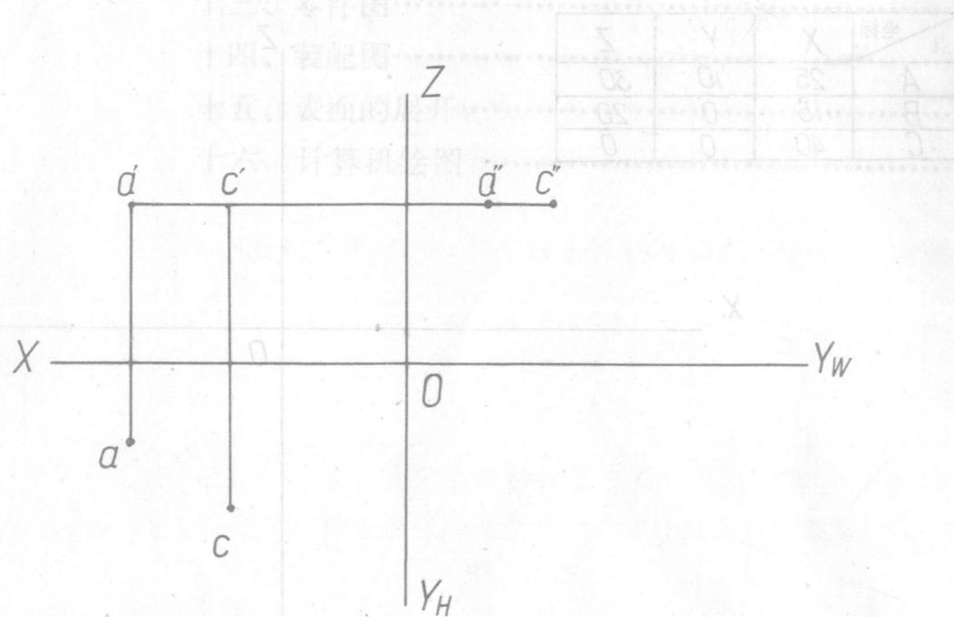
4. 求作与三个投影面  $H, V, W$  各相距 30 毫米的点  $A$  的三投影。
