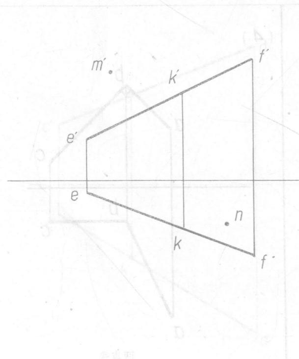
5. 过点 A 作直线与已知直线 BC 相交, 並使其交点距 V 面 25 毫米。
