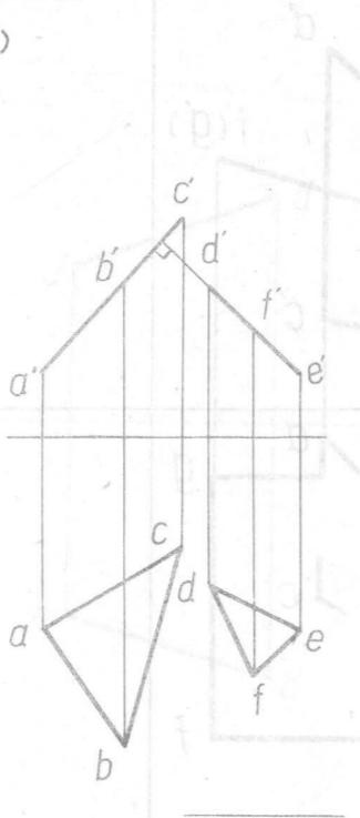
5. 过 K 点作平面垂直于两已知平面。
