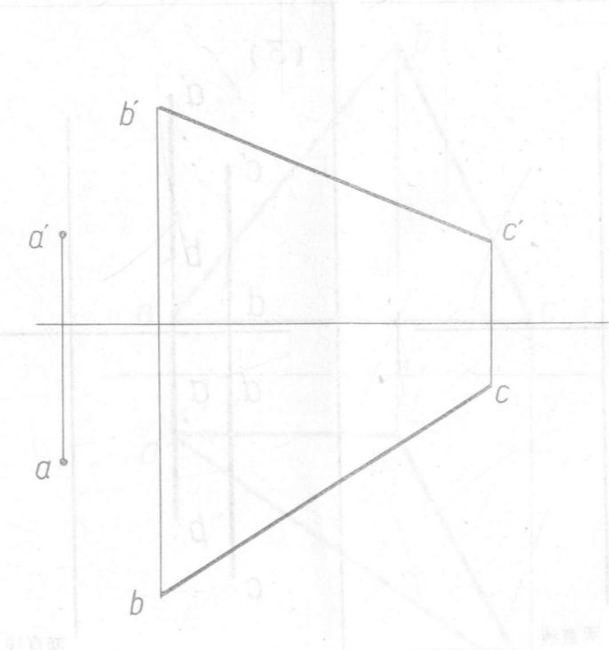
6. 作水平线距 H 面 25 毫米, 並与已知直线 AB, CD相交。
