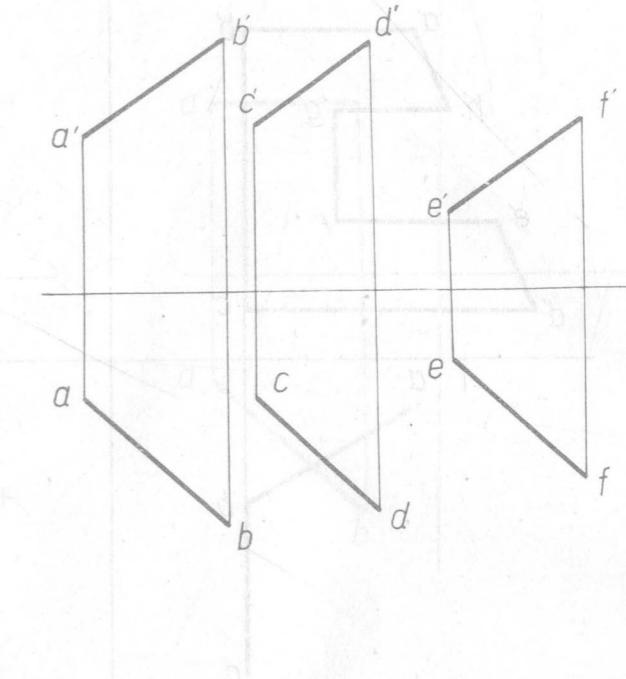
4. 已知直线  $AB$  和  $CD$ , 试分别过该两直线作两互相平行的平面。
