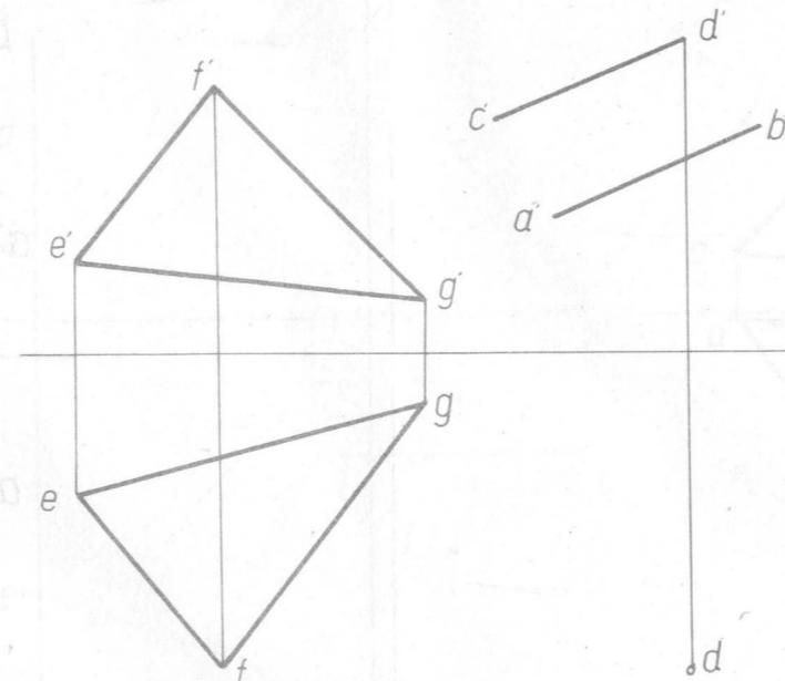
6. 已知平面  $\triangle ABC$  和  $\triangle DEF$  相互平行, 试完成  $\triangle DEF$  的水平投影。
