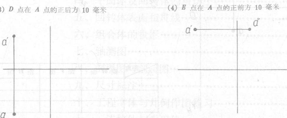
(3)  $D$  点在  $A$  点的正后方 10 毫米
