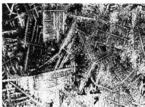
图5 氯化铵结晶完成后的树枝晶 (1×)
