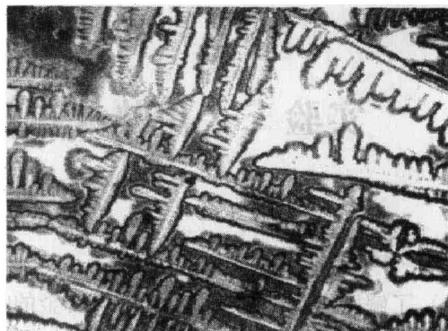
图3 氯化铵结晶过程结晶接近完毕 (50×)
