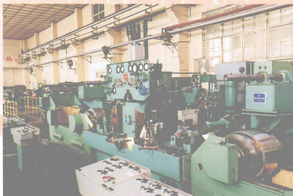
1990年，大连钢厂投产的精密合金20辊冷轧机组
