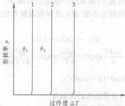
图 1-7 非粘性液相中的形核速率曲线示意图
