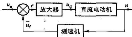
图 1-11 调速系统结构图
