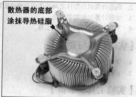
图 1-4 涂抹导热硅脂
