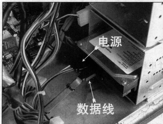
图 1-17 硬盘的线缆接口
