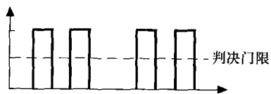
图 1-7 单极性归零码
