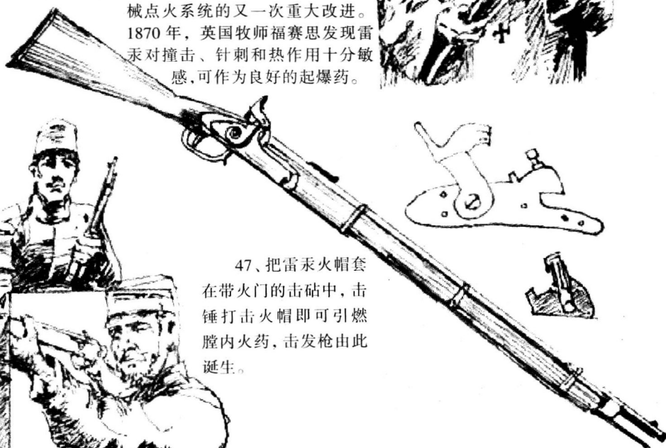
48、小小的火帽，极大地提高了枪械射击动作的可靠性。燧石枪大约每射击7发子弹就要瞎火1发，击发枪降为每200发出现1发瞎火子弹。
