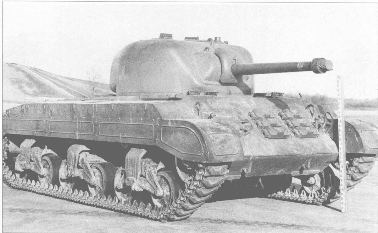
T22E1采用机械同步啮合传动。图中能看到它的用于试验的水平涡形弹簧悬挂，采用这种悬挂的车辆只是用于试验装备可自动装弹的75毫米炮。
