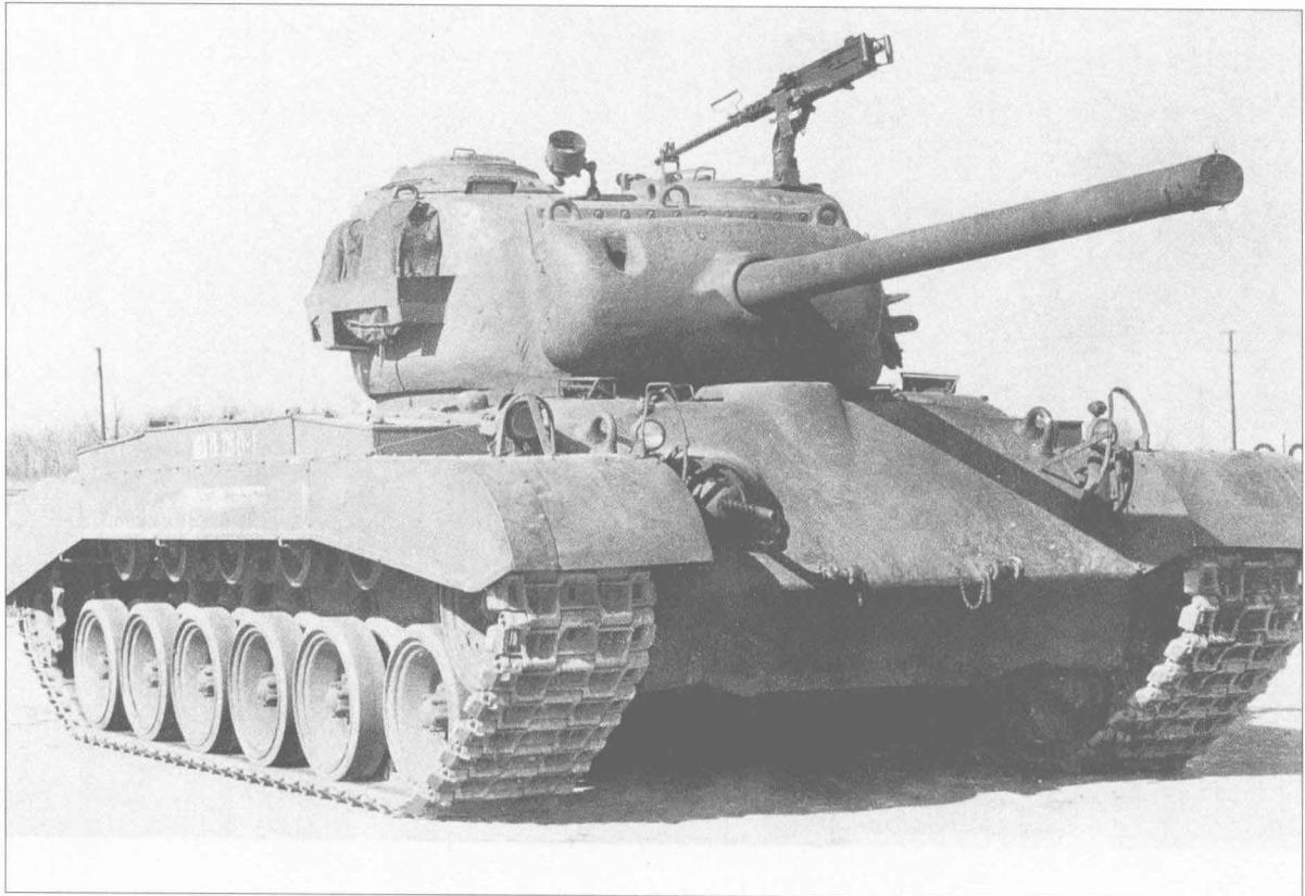
该车是首辆潘兴结构的坦克样车——T-26E1，生产于1944年3月。该车与生产型T-26E3有些细节上的不同，包括炮口制退器和装填手位置的旋转舱门。这种特别的车辆后来被改进，装备了威力更大的90毫米炮，被作为超级潘兴坦克运到欧洲战场。
