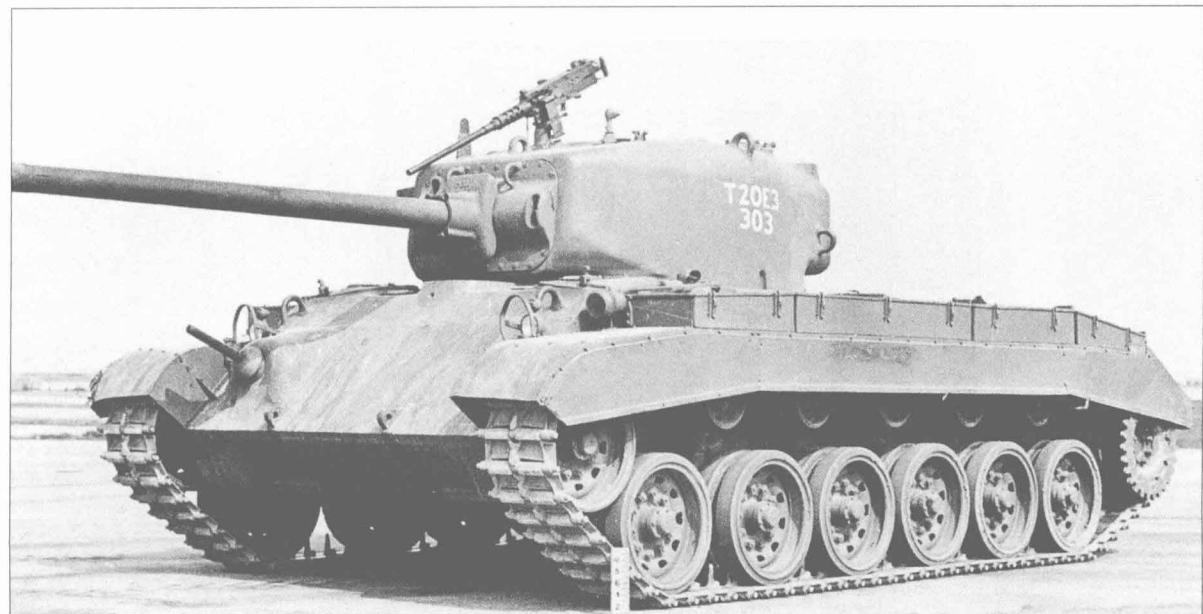
新研制的坦克被命名为T-20，采用与M6重型坦克相似的液压变力扭杆驱动。该计划后来还被扩展到包括采用机械传动的T-22坦克，以及采用电驱传动的T-23上。在进一步研制过程中，原型车之一的T-20E3被批准装备新型扭杆式悬挂，取代螺旋弹簧式悬挂，这种悬挂直到现在还是装甲车的一种典型悬挂设计方案。新型T20坦克和M4坦克之间的另一个明显不同是传动系统设计。M4的传动系统位于坦克前方，从动轴
