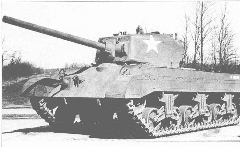
T-25和T-26两型坦克也采用电驱动系统，此后研制的改进型T-25E1和T-26E1坦克都换装扭杆式传动系统。T-26E1坦克采用液力扭杆和星型齿轮传动系统，1944年2至5月，美国位于勃朗的费希尔坦克兵工厂已经
