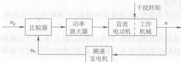
图 1-9 带偏差控制作用的速度控制系统的方框图
