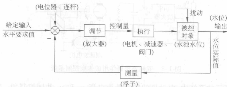
图 1-11 水位自动控制系统的方框图
