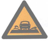
㉜ 过水路面标志
