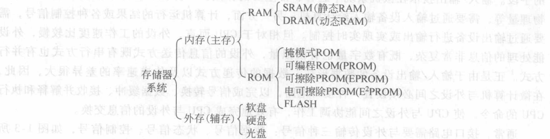
图 1-4 存储器系统组成
