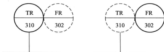
图 1-4 测量点较远时的复式仪表的图形符号
