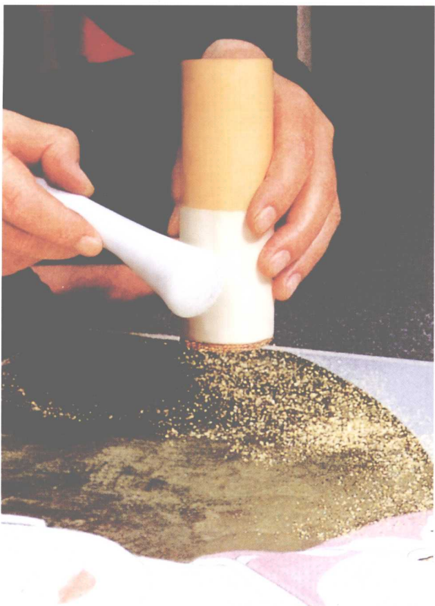
②左手执筛筒，内装以捣碎之金箔，以棒敲击之，使碎金箔如雨点般洒落，务必使其均匀。
