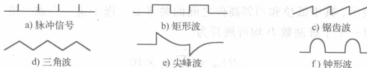
图 1-1 各种脉冲信号波形
