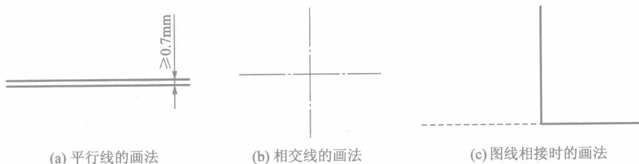
图 1-12 各种图线的画法
