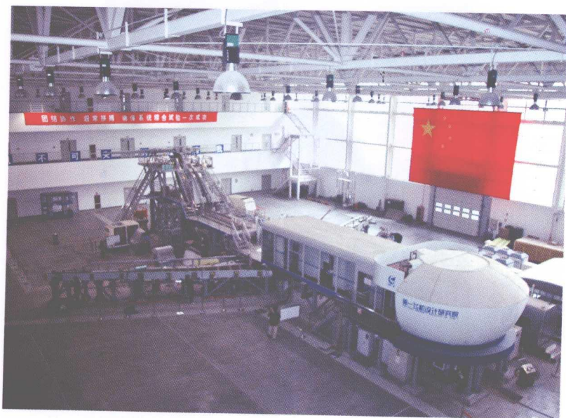
▲ 飞控铁鸟试验台是 ARJ21 - 700 飞机研制过程中进行飞控系统及其相关系统地面综合试验,并支持飞机飞行试验和产品支援必不可少的地面试验设施。(图片来源:中国航空报)
