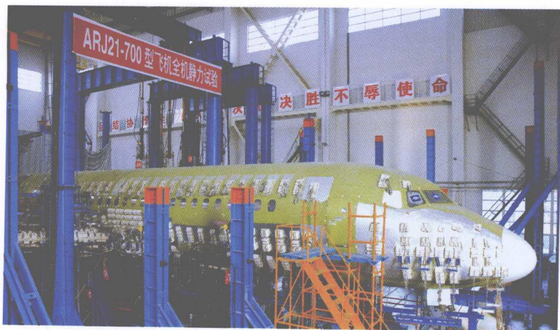
▲ 为了考核 ARJ21 - 700 飞机结构的响应是否符合适航规定的安全标准和设计要求,中国飞机强度研究所 456 厂房里进行了一系列静力试验。只有经过了这里的考验,才能证明设计出来的飞机是真正结实安全的。(图片来源:中国航空报)
