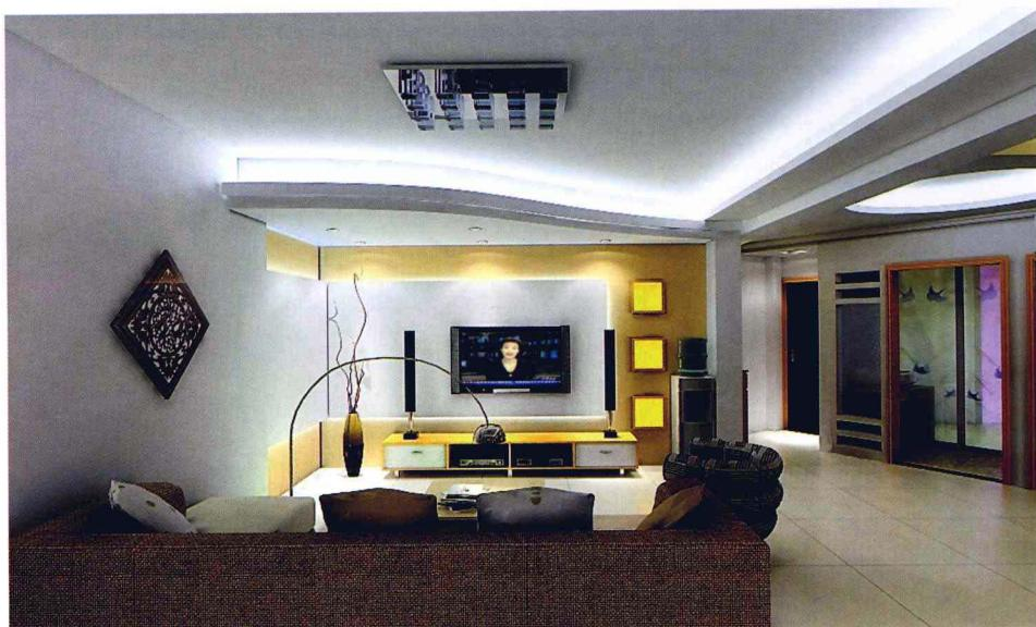
**右下图** 利用吊顶的高差设置灯带，丰富了视觉空间的同时光线也显得格外柔和。
