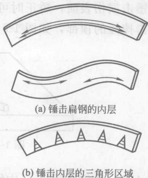
图 1-3 扁钢在宽度方向弯曲的矫正
