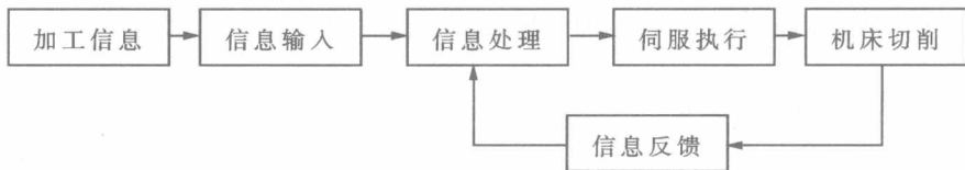
图 1-2 数控机床加工过程
