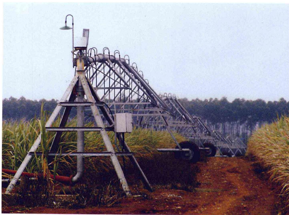
圆弧式喷灌：辐射面积 33.33 公顷，节水灌溉效率高
