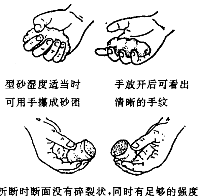
图 1—3 手攥法检验型砂
