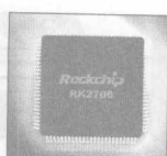
>>> 瑞芯微推出的符合CMMB标准的RK2708芯片
