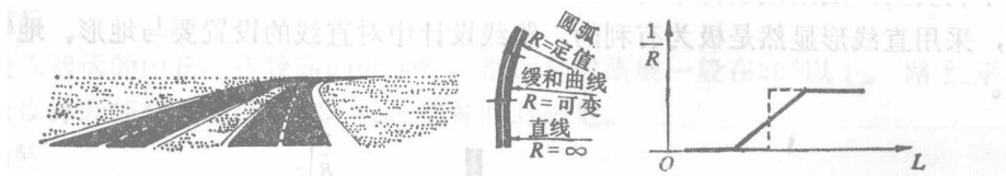
图 2-5 直线-缓和曲线-圆曲线与曲率
