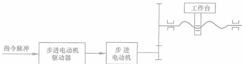
图 1-6 开环控制数控机床原理图
