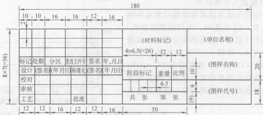
图 1-3 标题栏的格式尺寸
