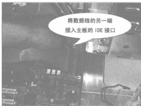
◎ 将数据线插入主板的 IDE 接口
