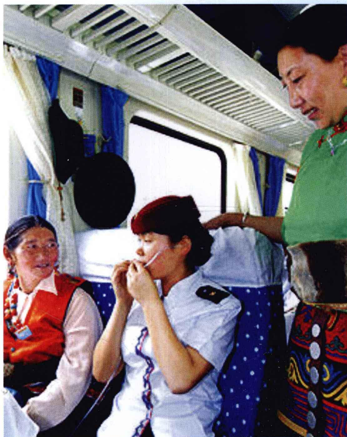
青藏列车内的管道供氧吸氧法
