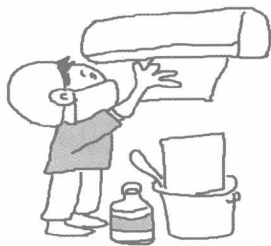
经常清洗空调过滤网
