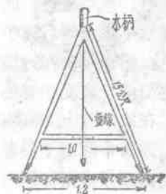
图10 三角水平器构造示意图
