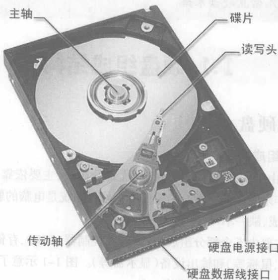
图 1-2 硬盘内部结构
