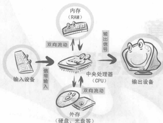
图 1-1 电脑系统的组成示意
