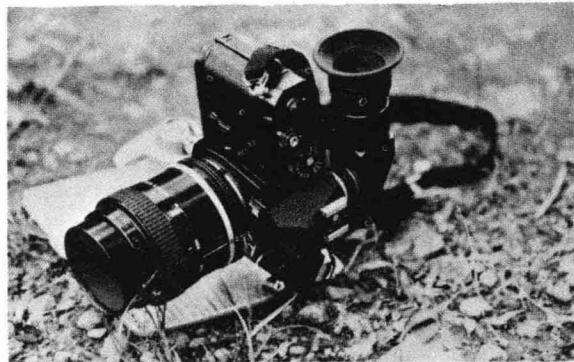
❷——三腳架雖然可以調整高度，但對位置極低的主題卻很難發揮效能，一般是把昇降桿倒過來裝在三腳架底下來解決這個問題。但，如果像拍攝野草等低位置攝影特別多時，不妨採用如圖般的固定方法。這只是在三夾板的中央部位裝上三腳架的螺釘而已。
