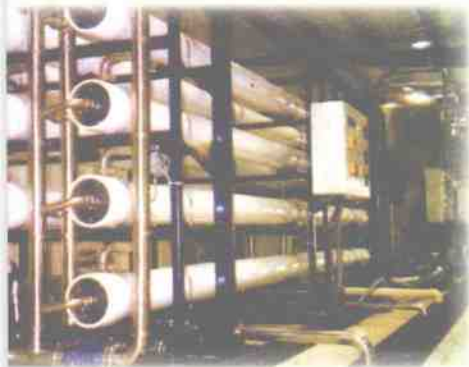
海水淡化装置利用了海龟眼泪能排出盐份的原理
