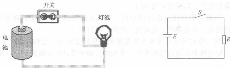
图1-2 手电筒电路与模型
