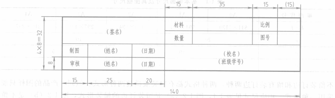
图 1-4 制图作业中推荐的标题栏格式
