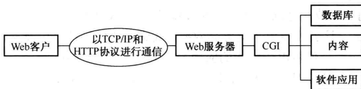
图 1-3 电子商务信息处理技术框架
