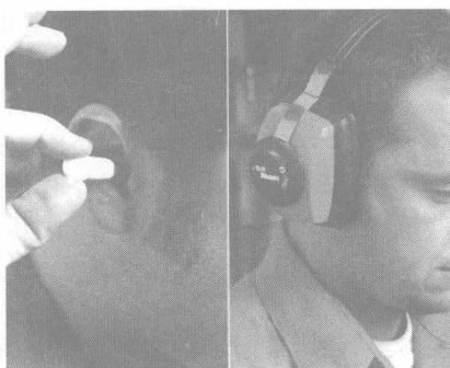
图 1.3 音量过大或音频过高时,机械师会采取以上措施保护听力
