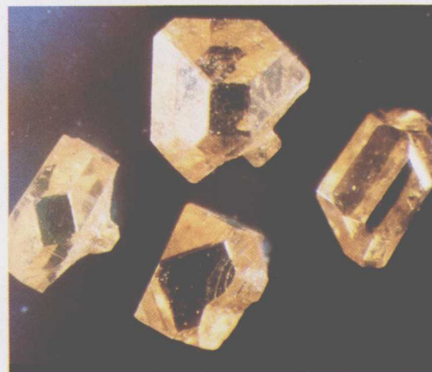
用晶种法生长的 金刚石单晶(图 中最大的 2.4 mm)
