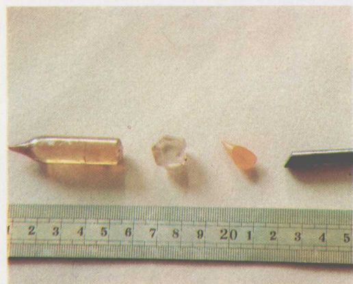
用升华法生长的 \text{ZnSe} (I、II) 和 \text{ZnTe} (IV) 单晶 及用碘输运法生 长的 \text{ZnS} (II) 单 晶(从左至右 I、 II、III、IV)
