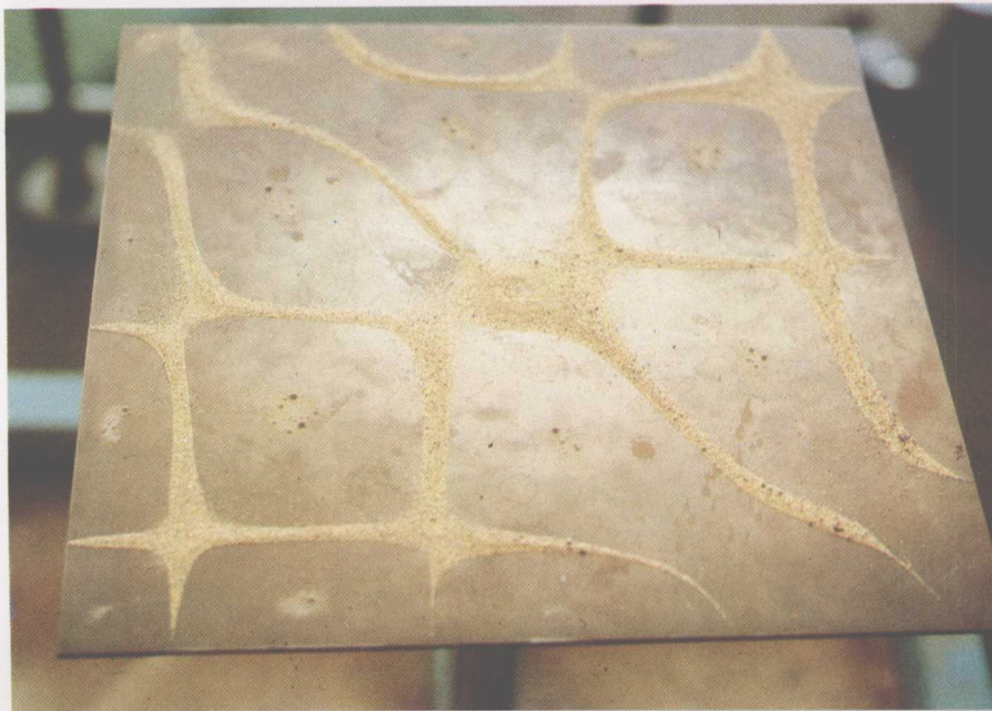
弓弦摩擦钢板使其振动，板上黄沙形成的克拉尼图形 汉 运摄
