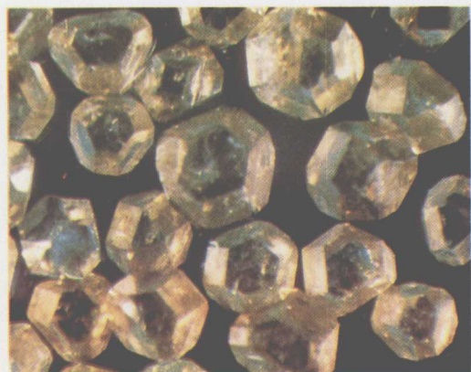
用金属薄膜法生长的金刚石单晶 (图中最大的径度为 2 mm)
