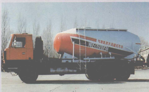
▲氣卸散裝水泥罐車：最大載重量15噸，平均卸料速度大於 1.4\text{ t}/\text{min} ，剩餘量小於0.3%，卸料水平距離為5米時，揚程可達到15米高度。
