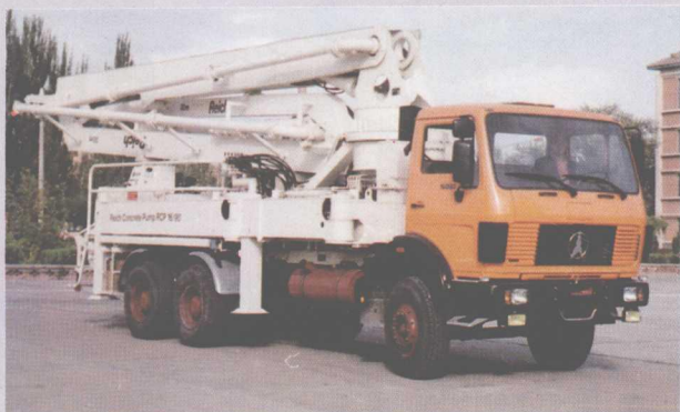
▲混凝土泵車：採用奔馳底盤，上車引進德國萊西公司 (Reich) 專有技術，布料桿長為33米、37米兩種，最大泵送量 94\text{ m}^3/\text{h} 。
