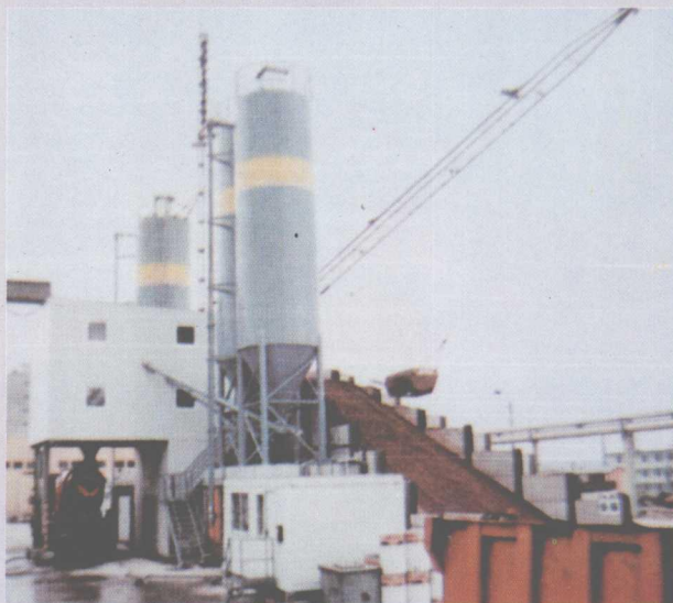
▲混凝土攪拌站：引進德國特卡公司 (Teka) 專有技術，攪拌機容積 500 \sim 3000\text{ 升} ，最大生產能力 100\text{ m}^3/\text{h} ，混凝土出料高度3.8米。
