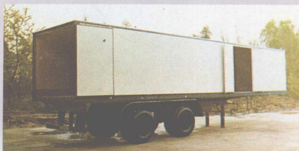
▲40' 集裝箱式半掛車、20' 集裝箱式全掛車：引進德國克勞納公司 (KRONE) 專有技術，車廂結構有帆布、多層板和鋁制廂板等多種形式。
