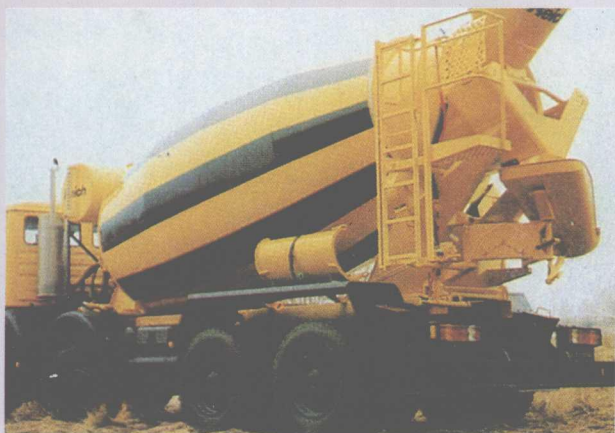
▲混凝土攪拌車：上車引進德國萊西公司 (Reich) 專有技術，攪拌筒容積有 6\text{ m}^3 、 7\text{ m}^3 、 8\text{ m}^3 ，最大混凝土裝載量19.6噸，攪拌迅速 16\text{ r}/\text{min} 。
