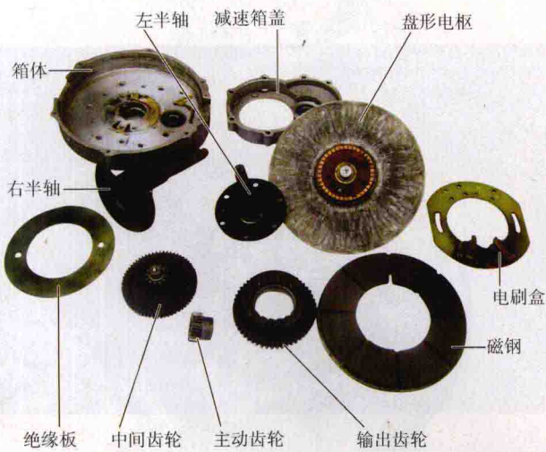
图1-24 有刷有齿电动机的结构
