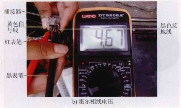
图3-5 霍尔相线电压的检测
