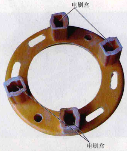
图1-14 电刷架的外形
