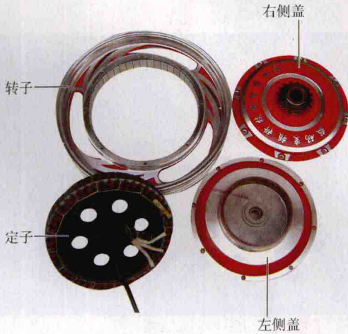
图1-17 无刷无齿电动机的结构
