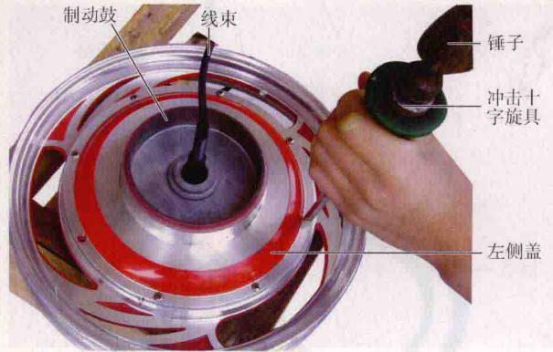
图2-96 冲击十字旋具的操作方法
