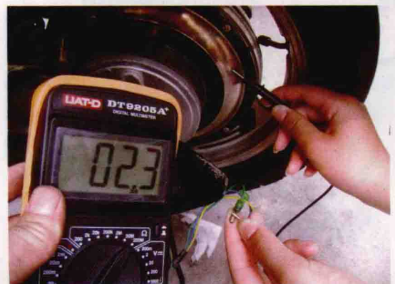
图5-18 电动机绝缘电阻的检测
