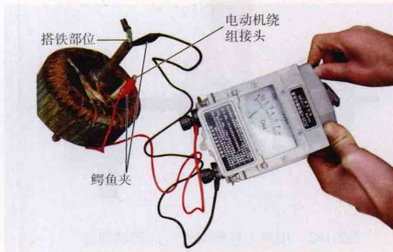
图3-11 兆欧表与电动机的连接
