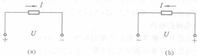
图 1-5 二端元件电压、电流的关联参考方向
