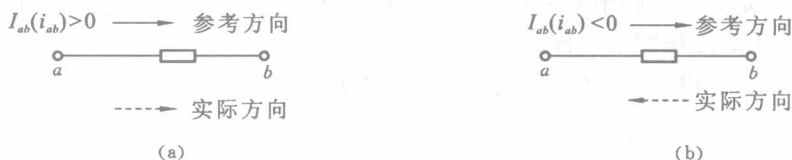
图 1-3 电流参考方向与实际方向
