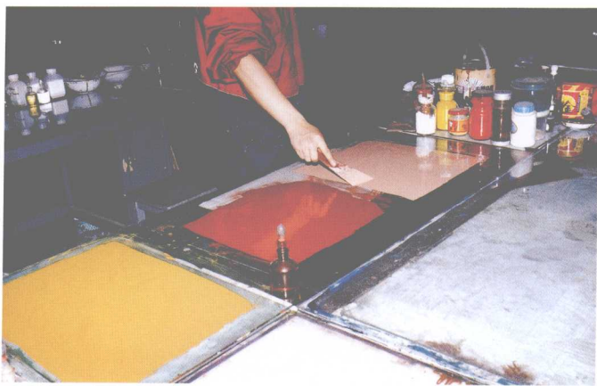
图23 干漆粉加工方法是将调制好的色漆刮在玻璃板或塑料布上,干后取下经电动粉碎机搅碎,再将其用罗筛过滤得到所需漆粉。
