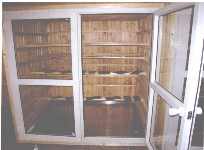
图 13 荫室，用吸水性好的杉木、桐木板制成，四壁喷水以保持荫室的湿度。
