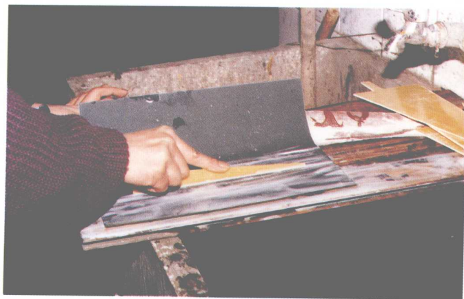
图 28 将裁切好的刮锹在磨石或水砂纸上磨平，并将铲漆部分磨薄，保持刮板的弹性。
