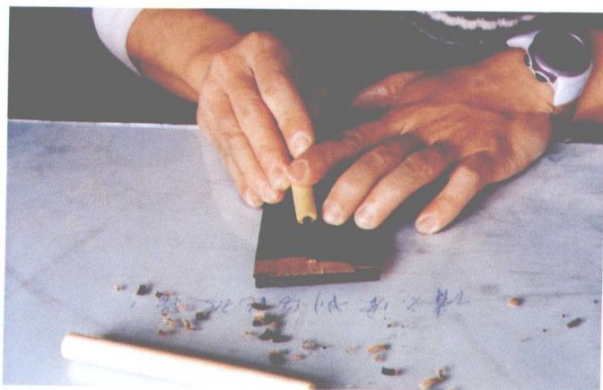
图 31 发刷是由桐木的木片将人发粘合而成，新刷子买来后需用刀除去刷毛旁的木片，削出约 1cm 的斜坡，露出发毛。
