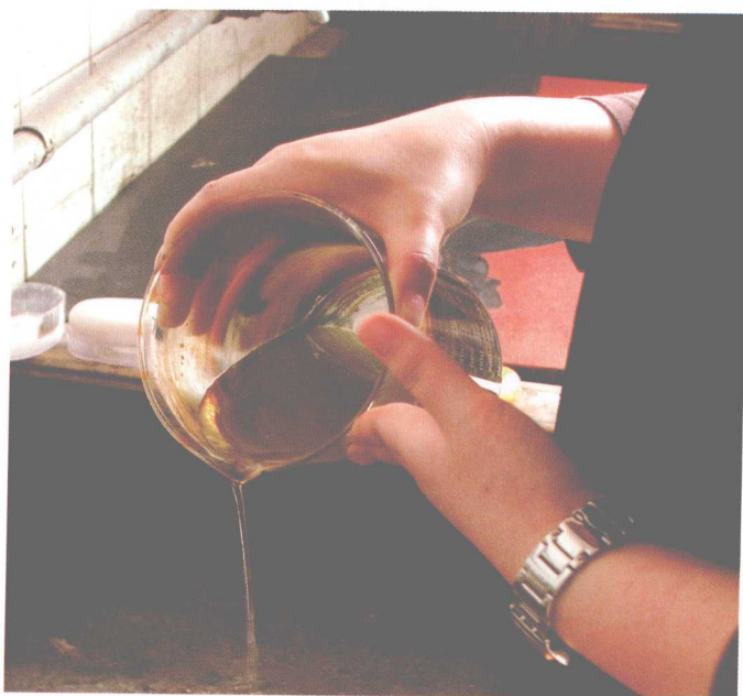
图 15 无水碳酸钠与硫酸亚铁反应后用清水漂洗的过程。
