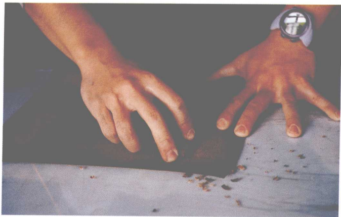
图 32 用刀削好后的发刷用水砂纸磨出刷毛，使其平顺，再将发刷泡在煤油里，用刮锹清理刷毛，使刷毛变得柔顺。
