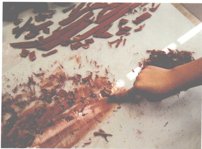
图24 将色漆刮在玻璃板上,干后用刀铲下。
