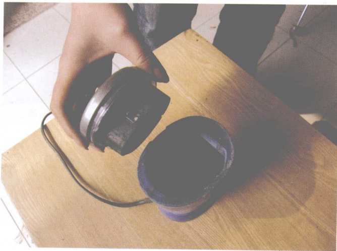
图25 用食品粉碎机加工干漆粉。
