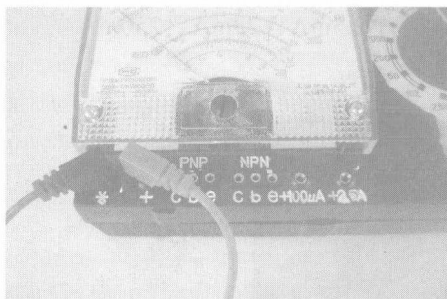
图 1-3 指针式万用表的表笔插孔
