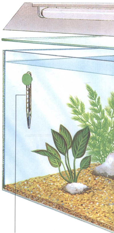
上图：把普通温度计装在鱼缸内壁玻璃上，位置的高低以便于读数为准。
