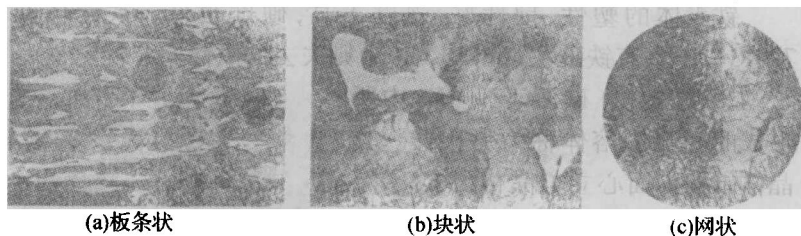
图 1-10 渗碳体的金相形貌
