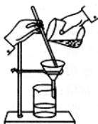
② 操作要点:一贴、二低、三靠。一贴:滤纸紧贴漏斗内壁(具体操作,在贴之前,用少量蒸馏水润湿后再贴);二低:滤纸边缘要低于漏斗边缘、液面要低于滤纸边缘;三靠:玻璃棒紧靠三层滤纸处、烧杯口紧靠玻璃棒、漏斗下端管口紧靠烧杯内壁,如图所示。
