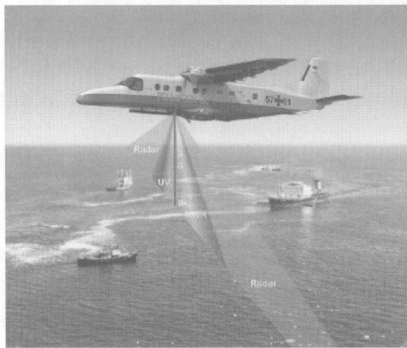
图 2 机载遥感监测海上溢油示意图
