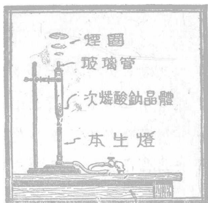
製造磷煙圈的簡便裝置。
