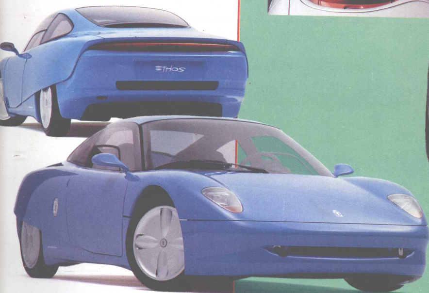
皮尼·法利那的伦理 II 型概念车为轻型构造，铝型材框架和塑料车身，一台二冲程发动机驱动。
